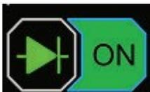
Рисунок 4. Отображение символа диода на экране тестера
